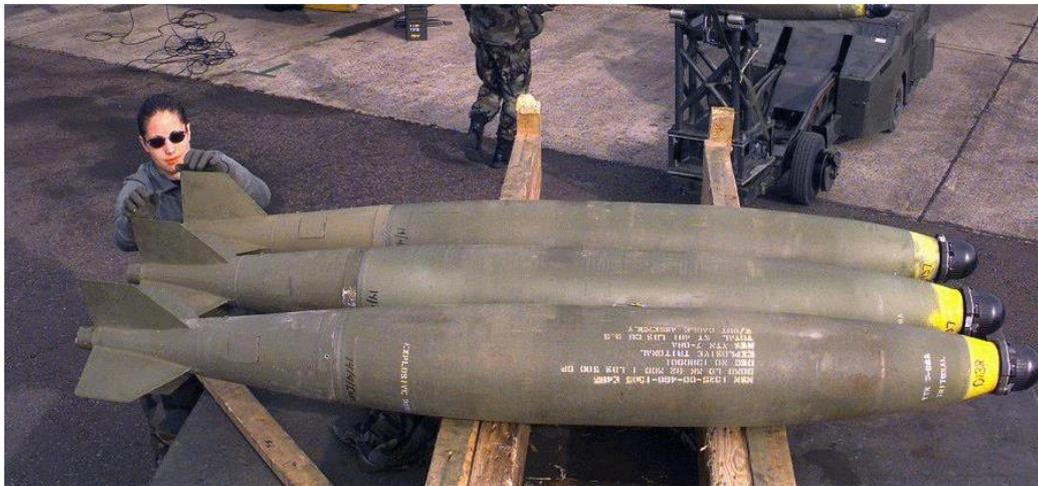
La MK-82 LDGP (Low Drag General Purpose) est la version lisse, non freinée de la série des MK-82. Elle possède l'avantage de pouvoir être tirée sur n'importe quel type de cible, seule ou en série. L'avantage de ne pas avoir de dispositif de freinage réside dans le nombre d'attaques différentes qui peuvent être menées avec ce type de bombe passant par les attaques en palier ou en loft.
