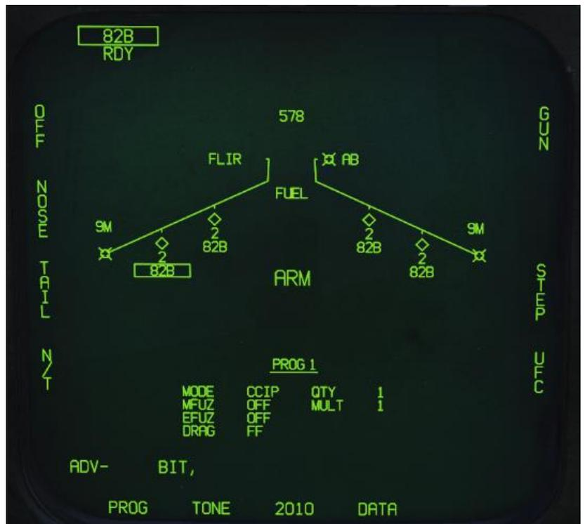
**EFUZ:** sélection du mode de détonateur électronique
