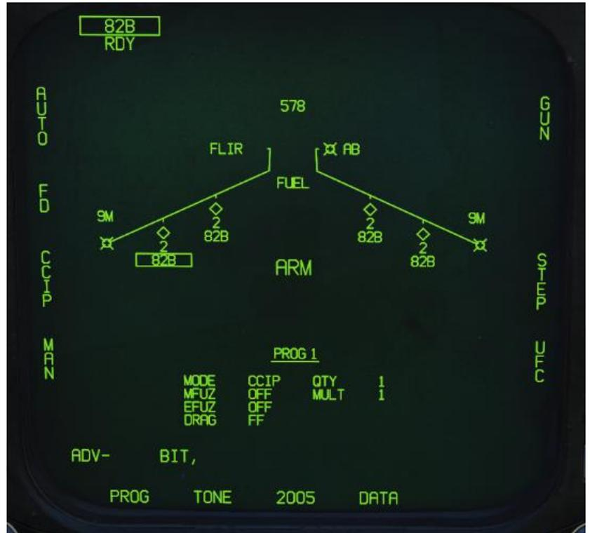
**MFUZ:** sélection du mode de détonateur mécanique
