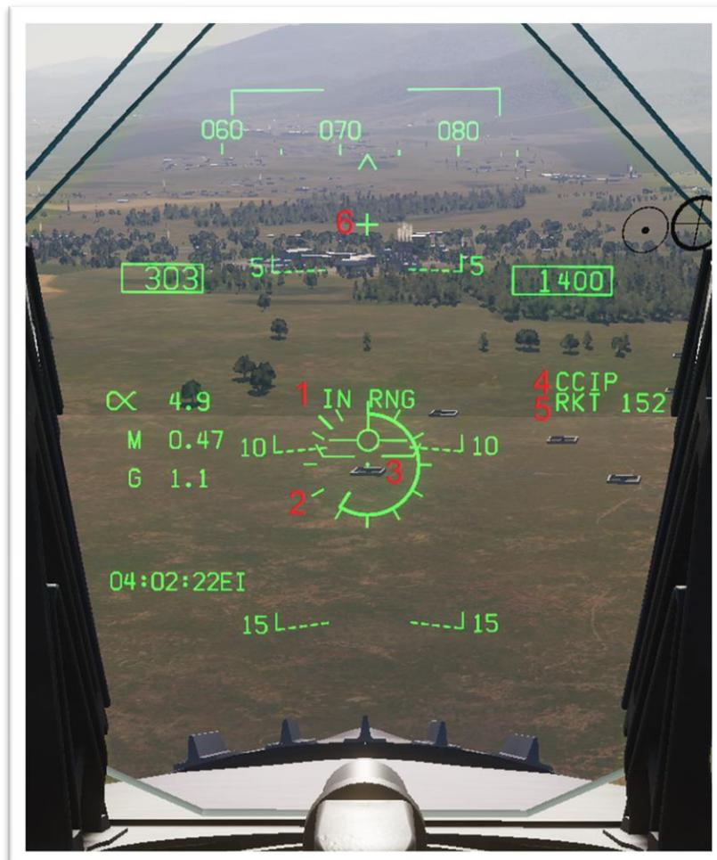
1. **Repère de portée (IN RNG)** : En CCIP lorsque le point du réticule de visée entre dans la portée de tir du canon, la symbologie « IN RNG » apparaît.
