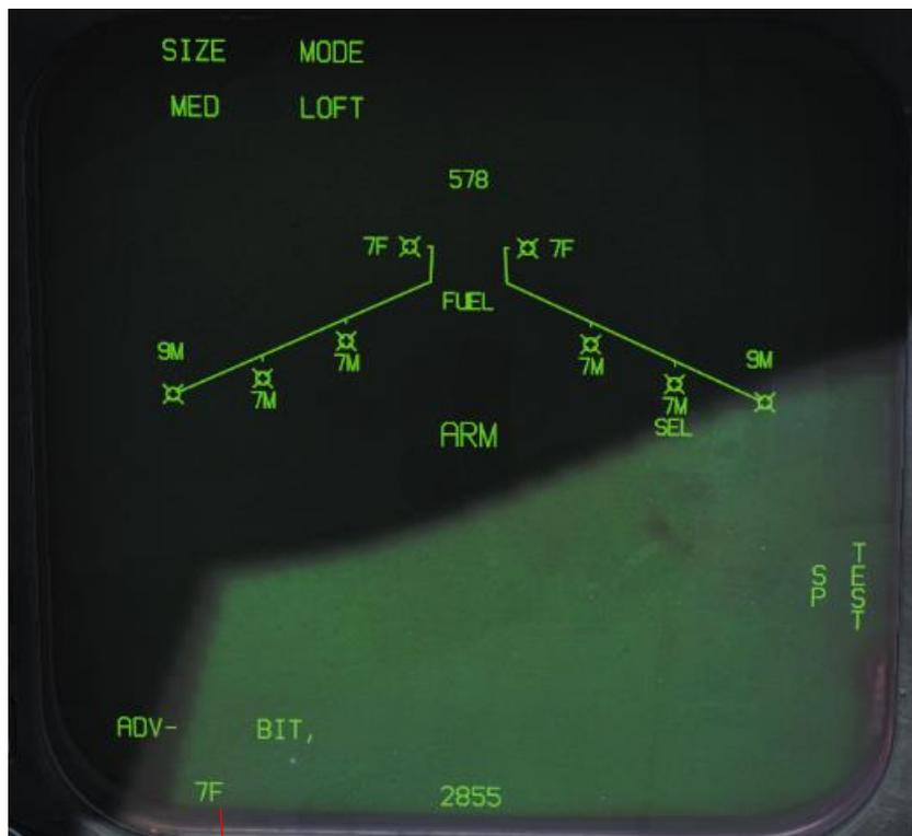
SIZE : permet de sélectionner la taille de la cible, pour un meilleur réglage de la détonation du missile (capteur de proximité)
