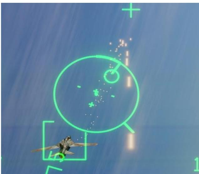
Tant que la détente est enfoncée, un signal "bullet at target range" « **BATR** » est affiché. Il s'agit de la visualisation (ici le petit cercle dans le réticule) de l'endroit où se trouvera la dernière balle tirée à la distance actuelle de la cible. En d'autres termes, si la BATR se trouve sur la cible, les obus toucheront probablement la cible.
