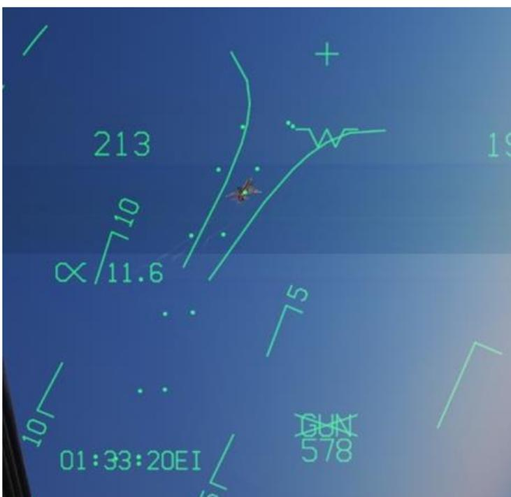
Avec le master ARM sur SAFE et SIM sélectionné sur la page STORES GUN, le repère FEDS peut être affiché sur le HUD une la détente pressée pour indiquer l'endroit où les obus arriveraient en utilisant le mode entonnoir. L'affichage FEDS se compose de 2 tracés électroniques séparés par l'envergure de l'aile de la cible.
