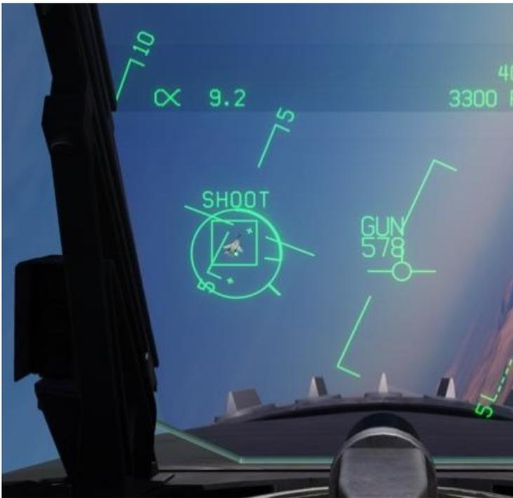
Un signal "SHOOT" est affiché au-dessus du réticule Gun Director lorsque le master ARM est ON, la portée est inférieure à la portée maximale et la distance prévue de l'impact de l'obus est inférieure à 20 pieds maximum de distance d'erreur
