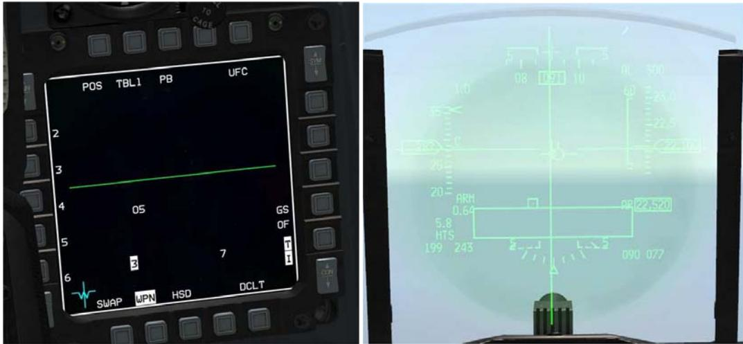
L'affichage des MFD est identique au mode EOM. Lors d'un tir en mode PB, l'erreur admissible de localisation en distance est de 5 NM dans l'axe perpendiculaire à l'axe d'arrivée du missile par rapport au point pris en référence du tir. Le capteur s'active à 10 NM et accroche directement la cible.
