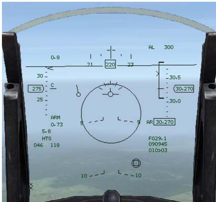
Sur ces figures, vous remarquez que le crochet de la zone de lancement dynamique est positionné sur la VTH. Ce crochet apparaît lorsque le système HTS a verrouillé une cible. Il indique les limites minimale et maximale de lancement d'un missile vers la cible. Vous disposez également d'une indication numérique sur la VTH comme le montrent ces mêmes figures. Cette indication ainsi que le petit cercle (ou ligne de détection) fournissent la direction à suivre pour atteindre la menace radar.
