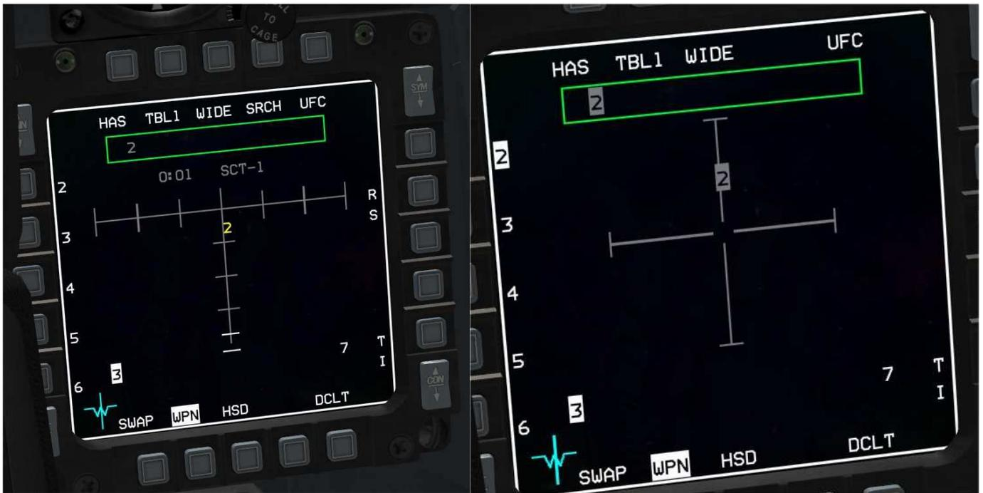
On note dans sa partie supérieure une zone rectangulaire où apparaît le type de menace détectée. On retrouve les tables de menace. Après, la sélectionner de la menace active via le curseur et un TMS Up. La mire change et on peut procéder au tir.
