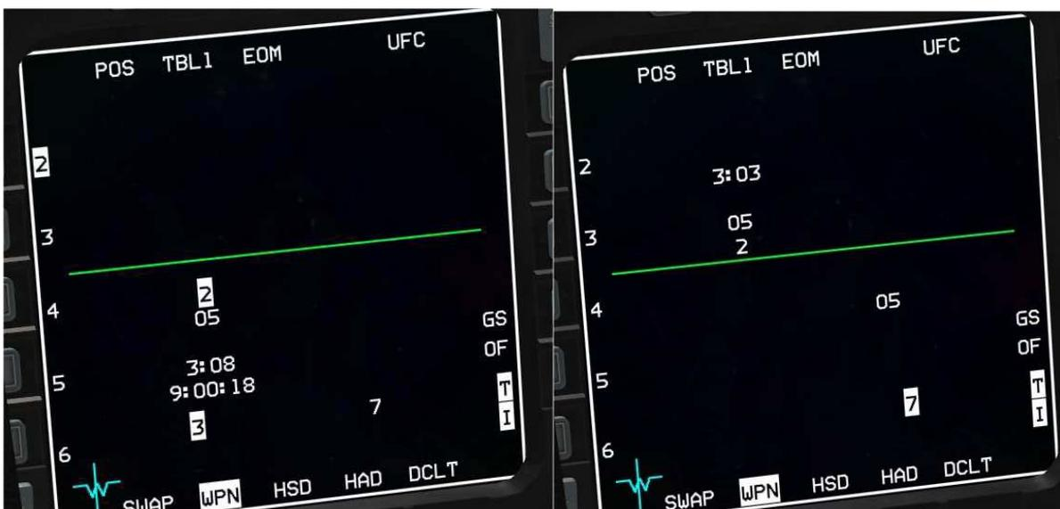
La menace SA2 a été sélectionnée, le temps de vol et le TOT du missile apparaissent dans la partie inférieure.
