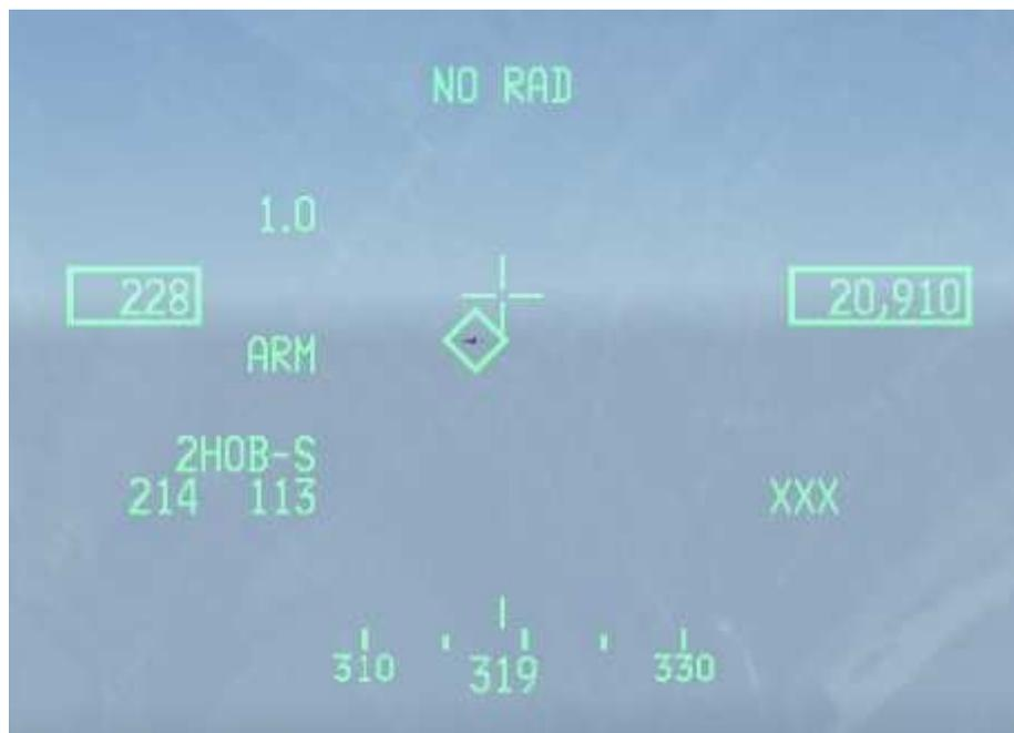
NB : Une fois l'autodirecteur « uncagé », si on perd le verrouillage radar ou qu'on l'annule volontairement, l'autodirecteur continue bien de suivre la cible : le losange continue de la suivre.
