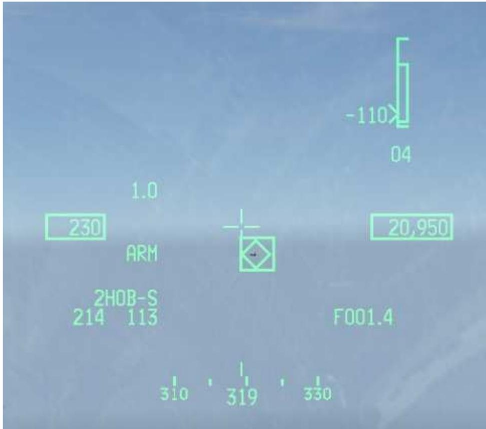
On vérifie avec la DLZ que la cible se trouve à portée, et que le son diffusé dans le casque est devenu aigu, puis on libère (*uncage*) l'autodirecteur : le losange devient plus grand. Il ne reste plus qu'à tirer. Inutile de continuer de suivre ensuite la cible : le missile est complètement autonome une fois tiré.
