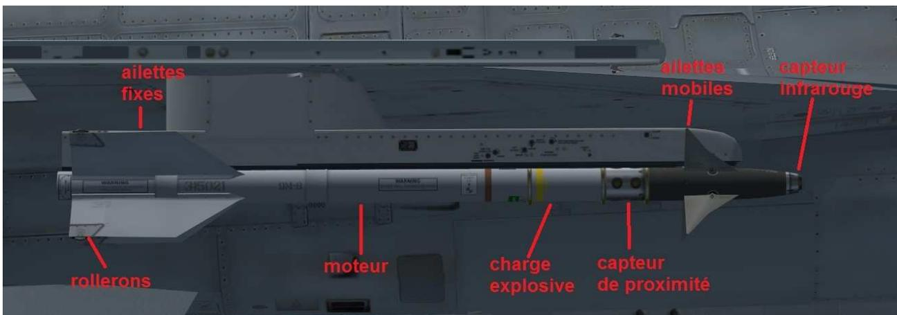
Ici, un AIM-9M sous l'aile d'un F-16.
