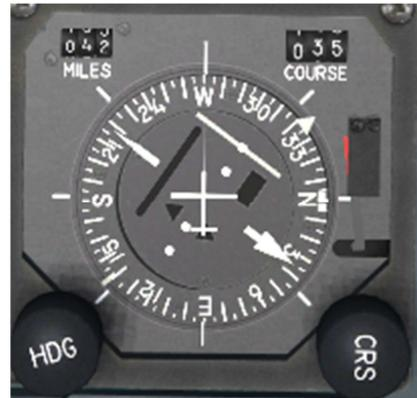
Au fur et à mesure que l'on se dirige vers l'ouest, notre QDR augmente (et on peut voir la queue de l'aiguille "remonter") :
