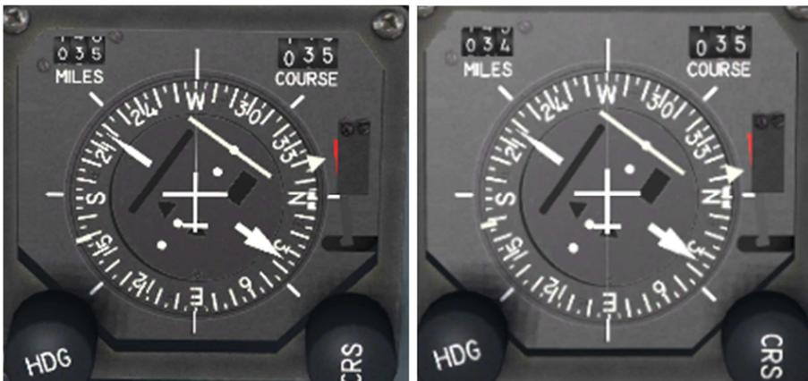
Si on imagine à nouveau notre avion à la place de la queue de l'aiguille, et la balise au centre du HSI, on voit bien que notre avion remonte les radiales au fur et à mesure qu'on se dirige au cap 270.
