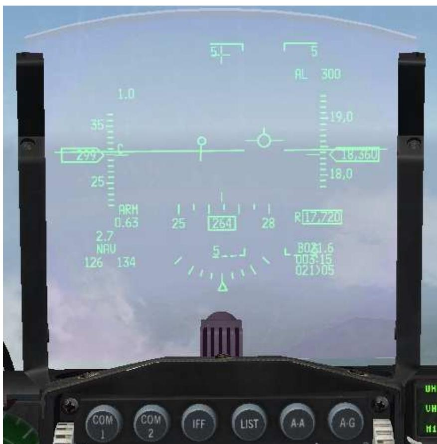
Ici l'avion est au cap 264, et le vent provient du 170, c'est-à-dire de la gauche presque perpendiculairement. Le FPM se trouve décalé vers la droite, il est « poussé » sur le côté par le vent. Notez que les barres d'attitude suivent également le FPM.
