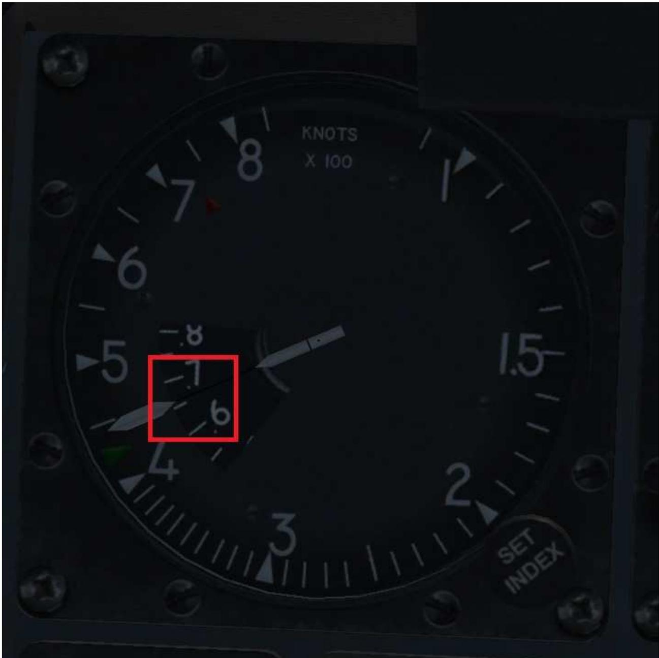
Le corps de l'aiguille passe sur le cadran intérieur entre la graduation 0,65 et la graduation 0,7 : l'avion file bien à 0,67 fois la vitesse du son.
