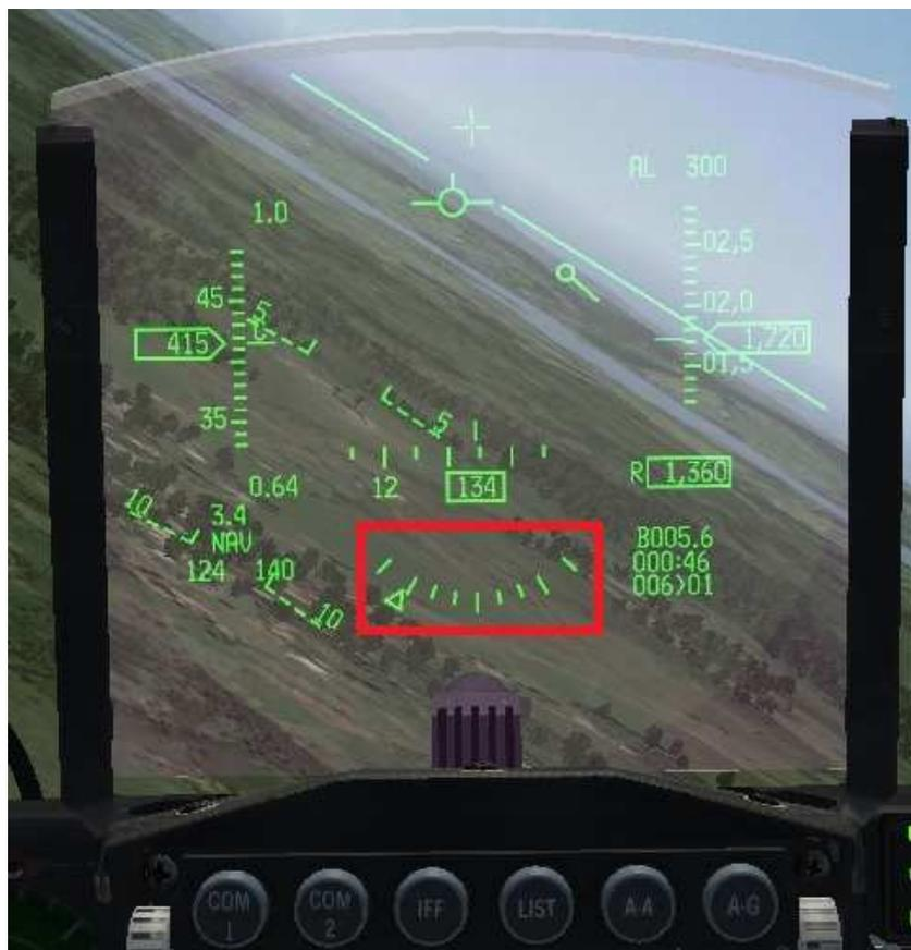
L'avion est incliné à gauche. Sur l'échelle de roulis on lit l'inclinaison grâce à la position du triangle sur l'échelle. Ici l'inclinaison est d'un peu plus de 30°.
