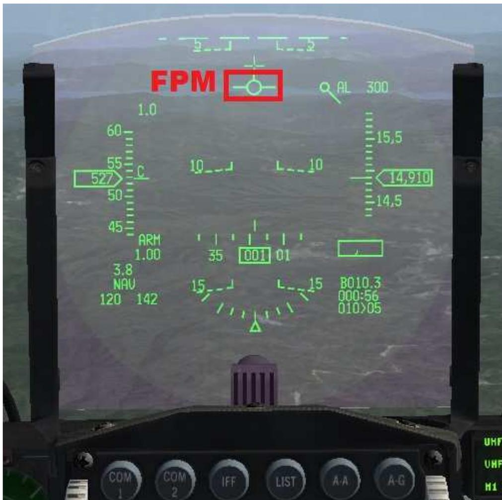
Le FPM donne très visuellement la trajectoire de l'appareil. Ainsi ici si le pilote laisse l'avion filer sur sa trajectoire actuelle, il terminera très précisément dans la rivière qu'on voit au loin, sur laquelle le FPM semble superposé.
