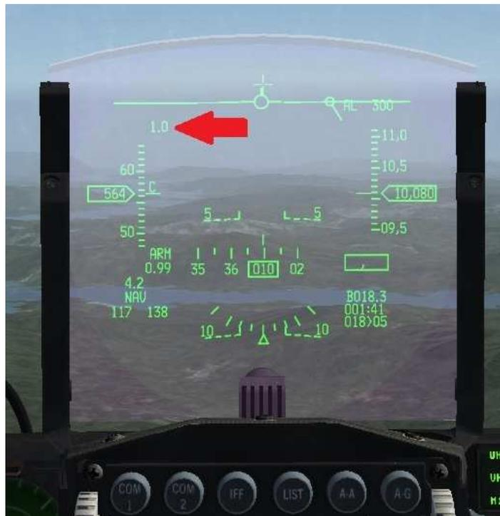
Avion en palier (FPM sur la barre d'horizon), ailes à plat : le facteur de charge est de 1G.
